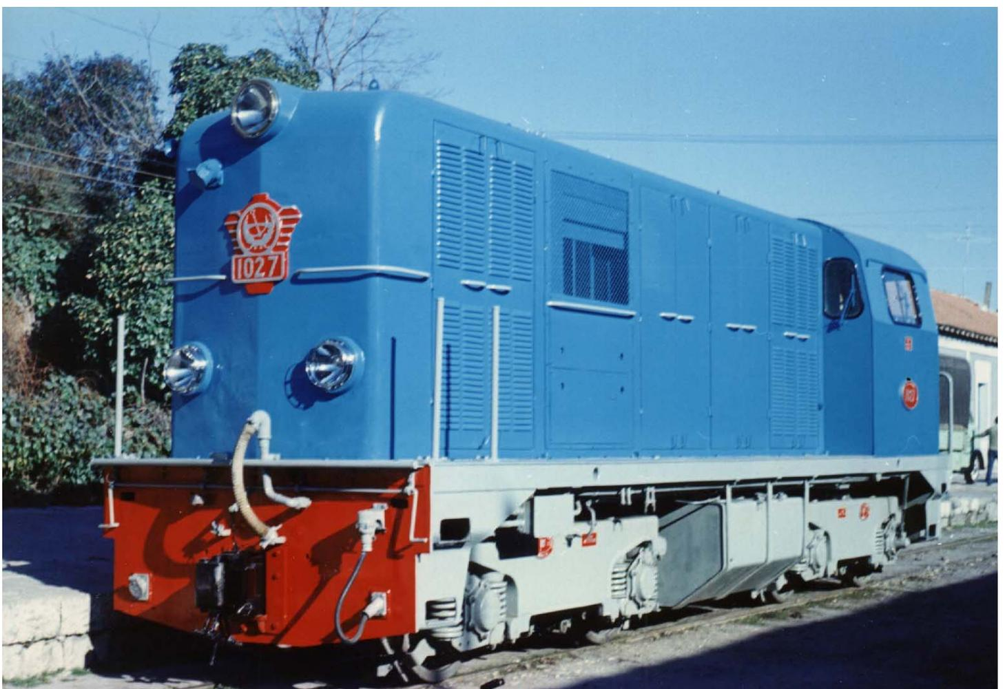
Niño Jesús (Espagne, Madrid) — 1959 — Compañia del Ferrocarril de Tajuña — La locomotive diesel électrique n°1027, construite par Euskalduna-General Electric (385/1958) sous licence Alsthom, est prête pour les essais lors de son arrivée sur le réseau. Elle arbore dans sa moustache, au dessus du numéro de parc, le sigle du M.O.P : Ministerio de Obras Publicas (Ministère des Travaux Publics), (Collection Philippe Royer, DR).
