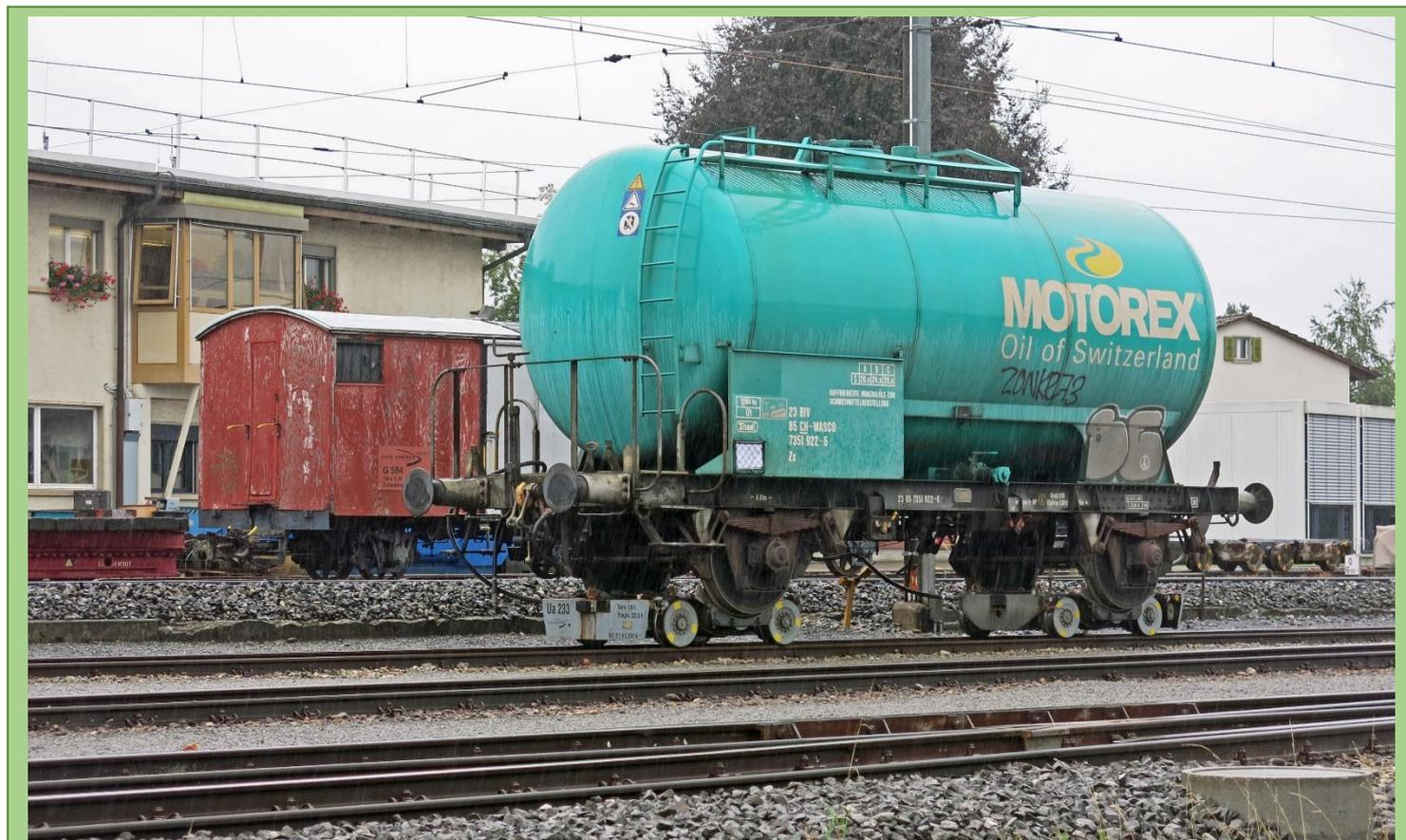
Langenthal : un wagon citerne type Zs de transport de lubrifiant, chargé sur 2 bogies porteurs, le Ua233 et le Ua228. Ces bogies porteurs ont été construits par les ACMV Ateliers de Construction Mécaniques de Vevey en 1985. - Photographie Patrick Etiévant -
