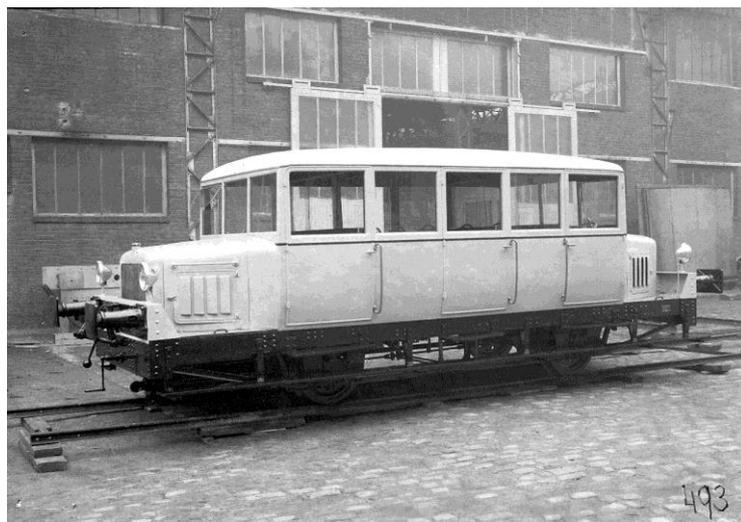
Cette draisine Campagne à longue caisse et deux capots, est sans doute une draisine d'inspection commandées par l'Alsace-Lorraine et livrée en 1933, sous le numéro de construction 1729. Le coffre arrière doit recevoir les bagages des inspecteurs. On notera la présence de 3 portières sur la face visible. Elle appartiendra peut-être au groupe 5 de la Région Est.
