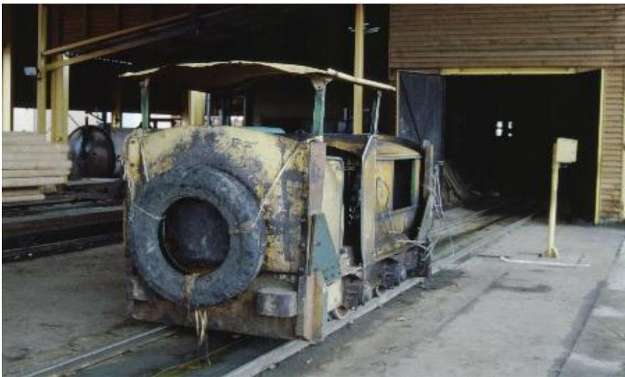
voies entre elles, puisqu'elles sont pratiquement toutes indépendantes . Cet engin est équipé d'un moteur Deutz à deux cylindres à refroidissement par air, qui, lui, semble d'origine .
