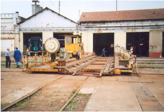
*Le pont transbordeur sud, situé côté raccordement SNCF, est un passage obligé pour tous les véhicules entrant ou sortant de rénovation.*
