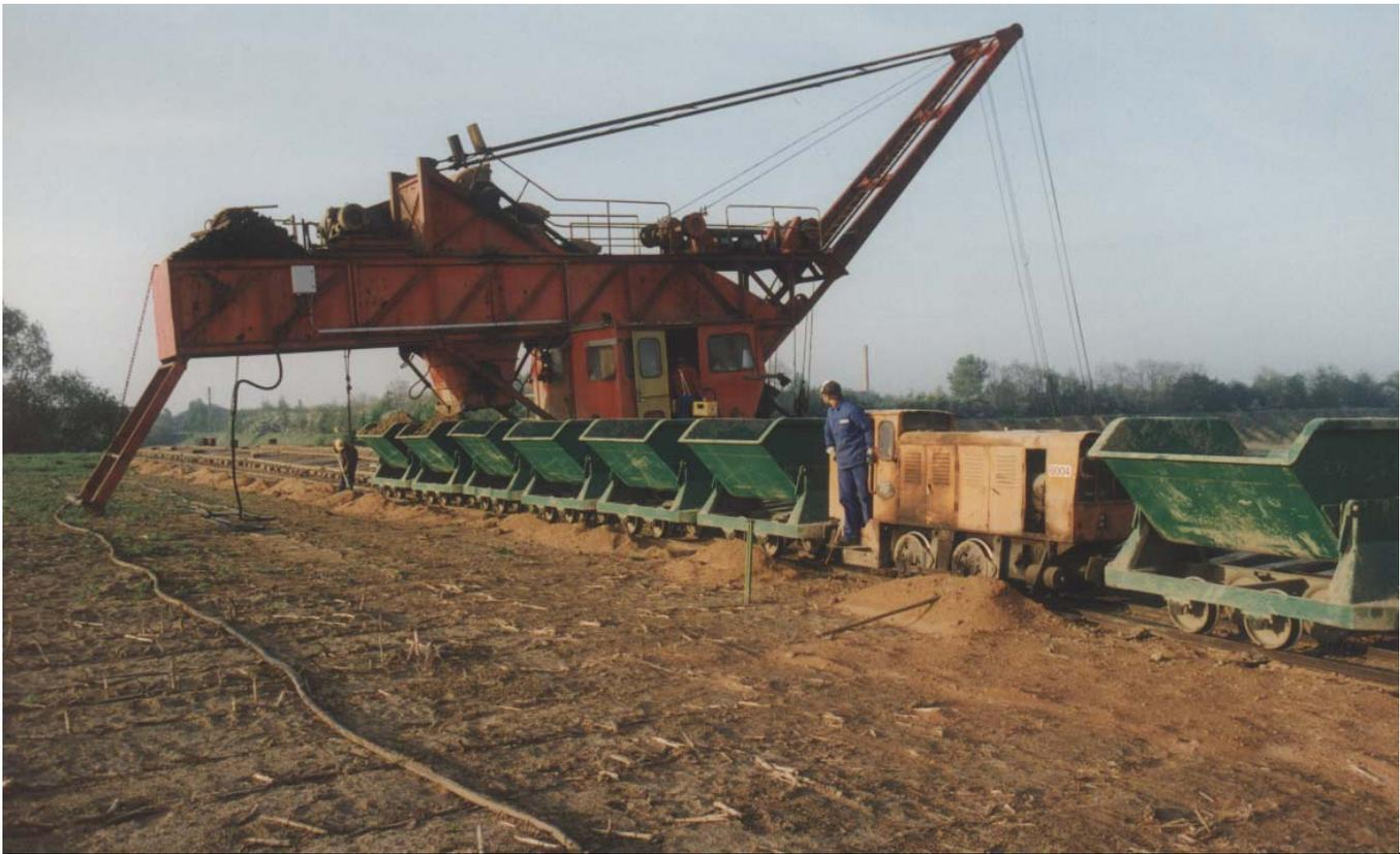
**Ploegsteert (Belgique) — mai 1996 — Briqueterie de Ploegsteert — voie de 500 mm — Le locotracteur MOES n°6004 pousse une rame de wagonnets à caisse basculante au fur et à mesure que l'excavateur assure le chargement. Ce train est composé de wagons modernes à caisse et châssis soudés construits dans les années 1980 (photographie : Patrick Etiévant).**
