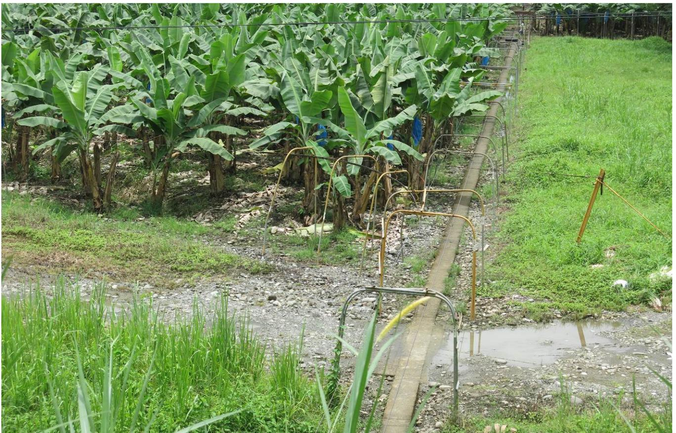
Premier aperçu des systèmes monorail ou systèmes à câbles desservant les bananeraies, ici à double voie avec un câble comme rail porteur. Les cadres sont espacés de 2 m sur la ligne principale et de 8 m sur l'embranchement à gauche – Photographie Patrick Etiévant -
