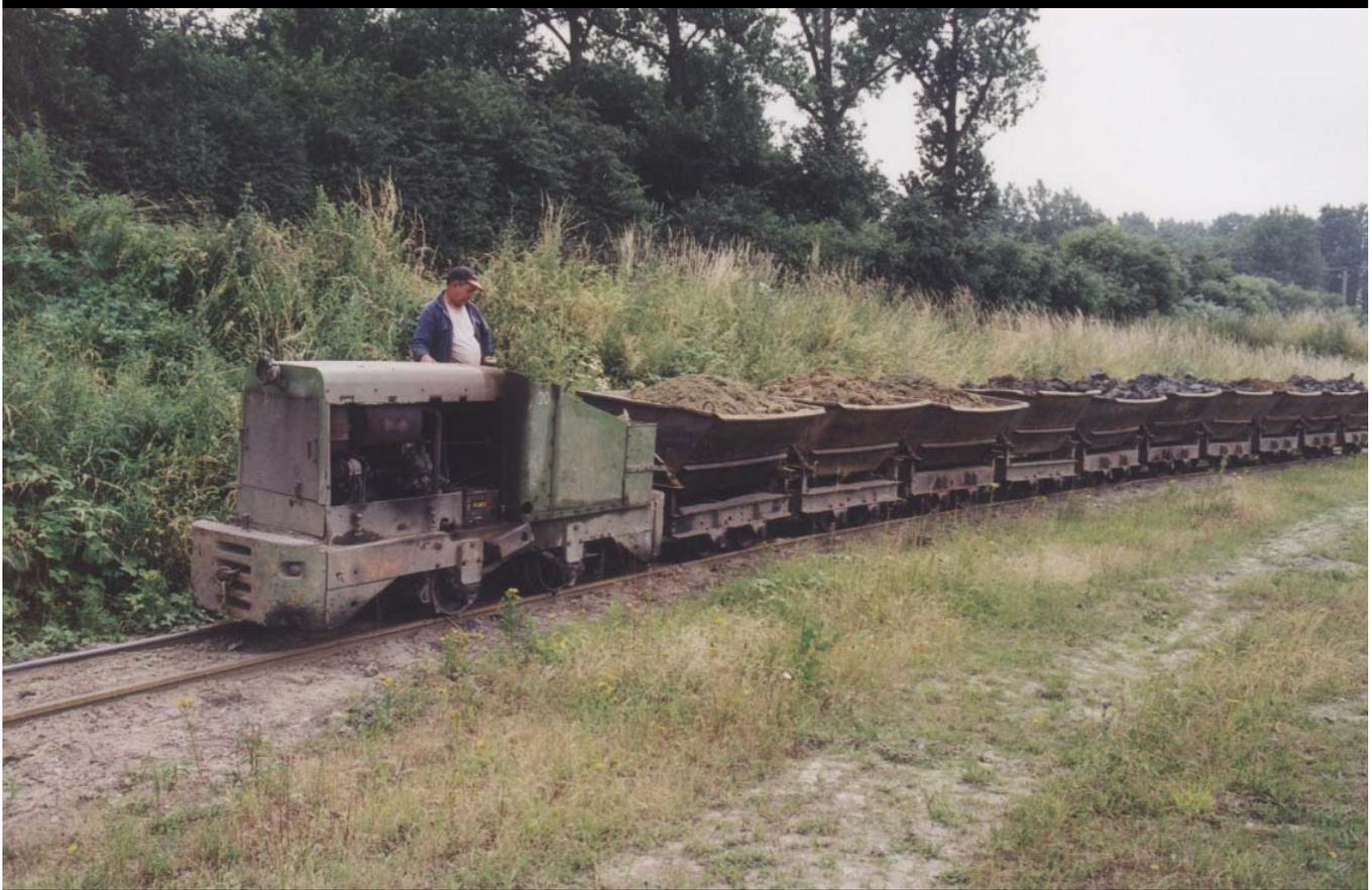
Région Nord Pas de Calais — Mars 1998 — Tuilerie et Briqueterie — voie de 600 mm — Le locotracteur Ruston & Hornsby n°20 refoule une rame de 10 wagonnets chargés d'argile. Cet engin du type 40 DL, tarant 4,5 tonnes et équipé à l'origine d'un moteur diesel de 40 CV, assure sans défaillance la traction des trains dans la rampe assez raide située à la sortie de la carrière (photographie : Patrick Etiévant).
