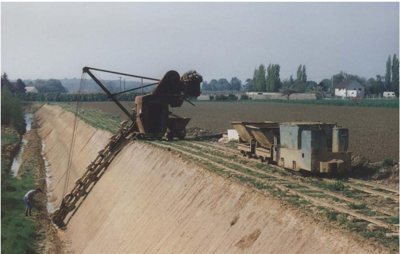
Région Ile de France — Juin 1995 — Tuilerie & Briqueterie — voie de 500 mm — Le locotracteur électrique à accumulateurs Milhoud SATME type TM 14 patiente en tête d'une rame. Equipé de 2 moteurs de 7 CV et tarant 2 tonnes, il tracte allégrement les quelques wagonnets d'argile chargés par l'excavateur à élince articulée travaillant en fouille fabriqué par DEMAG (photographie : Patrick Etiévant).
