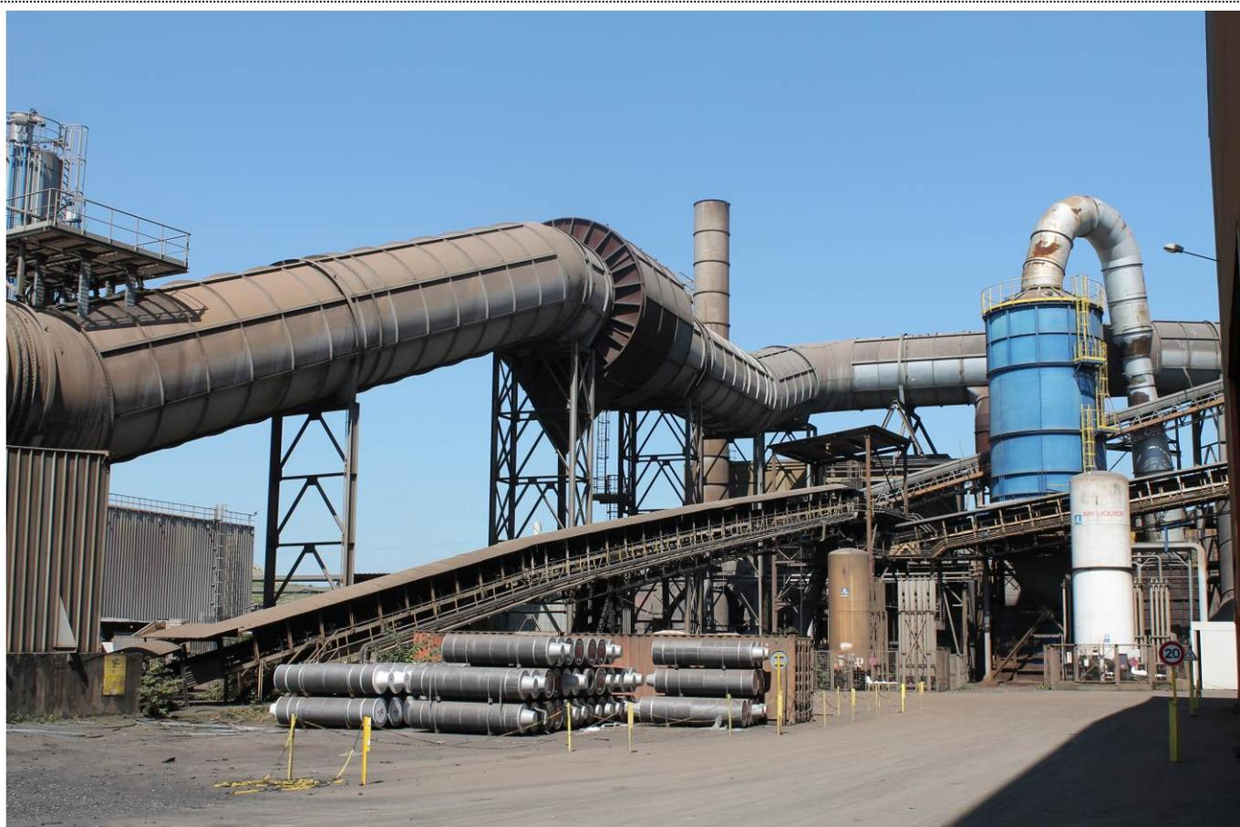
Vue de l'aciérie électrique de Trith Saint Léger : le système de dépoussiérage du four électrique; à gauche, des cylindres de laminoirs neufs en stock – photographie Dominique Mercier
