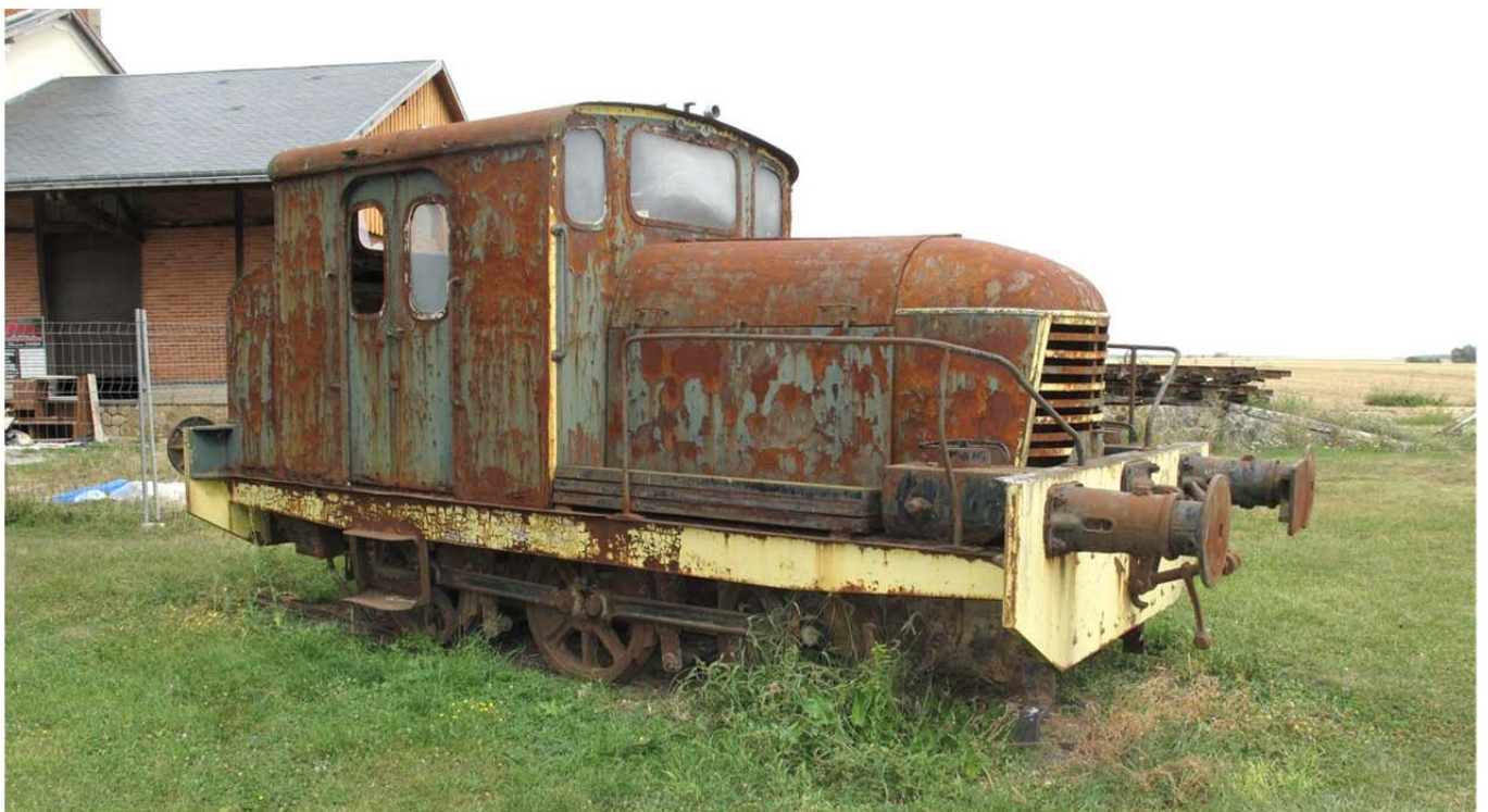
Argy – un locotracteur CFD à la vie mouvementée : le n°4 CFD Neuillé Pont Pierre construit en 1939 à partir de la locomotive à vapeur n°4 des CFD Indre et Loire (Couillet 819/1885) à voie métrique, mis en voie normale par CFD en 1958, précédemment employé par les HBA Houillères du Bassin d'Aquitaine à Carmaux, puis les vins Méjunk Carcassonne ; avant de rejoindre Argy – Photographie Patrick Etiévant -
