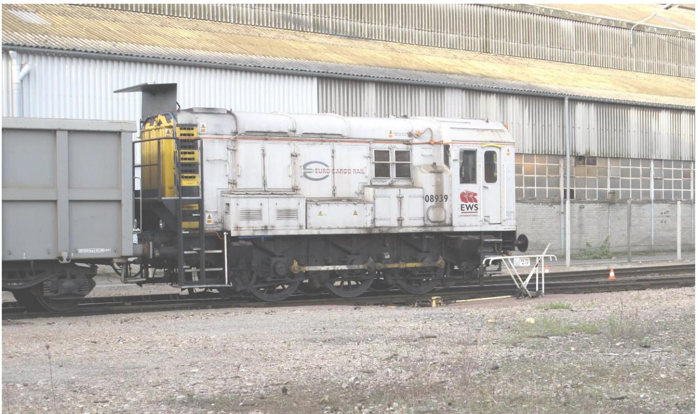
La locomotive 030 English Electric n°08939 d'ECR employée à Déville les Rouen. Une plateforme surélevée a été aménagée devant le radiateur de la locomotive. Un agent de manœuvre y prend place lorsque l'engin circule capot en avant sur la ligne principale : il est en liaison radio avec le conducteur qui a dans ce cas une visibilité réduite – photographie Patrick Etiévant
