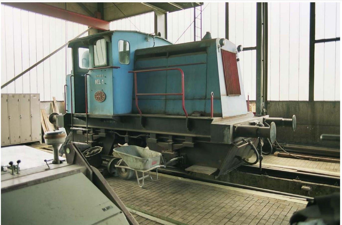
Le locotracteur diesel électrique GEBUS VEL1 dans la remise de Mixnitz – Photographie Patrick Etiévant
