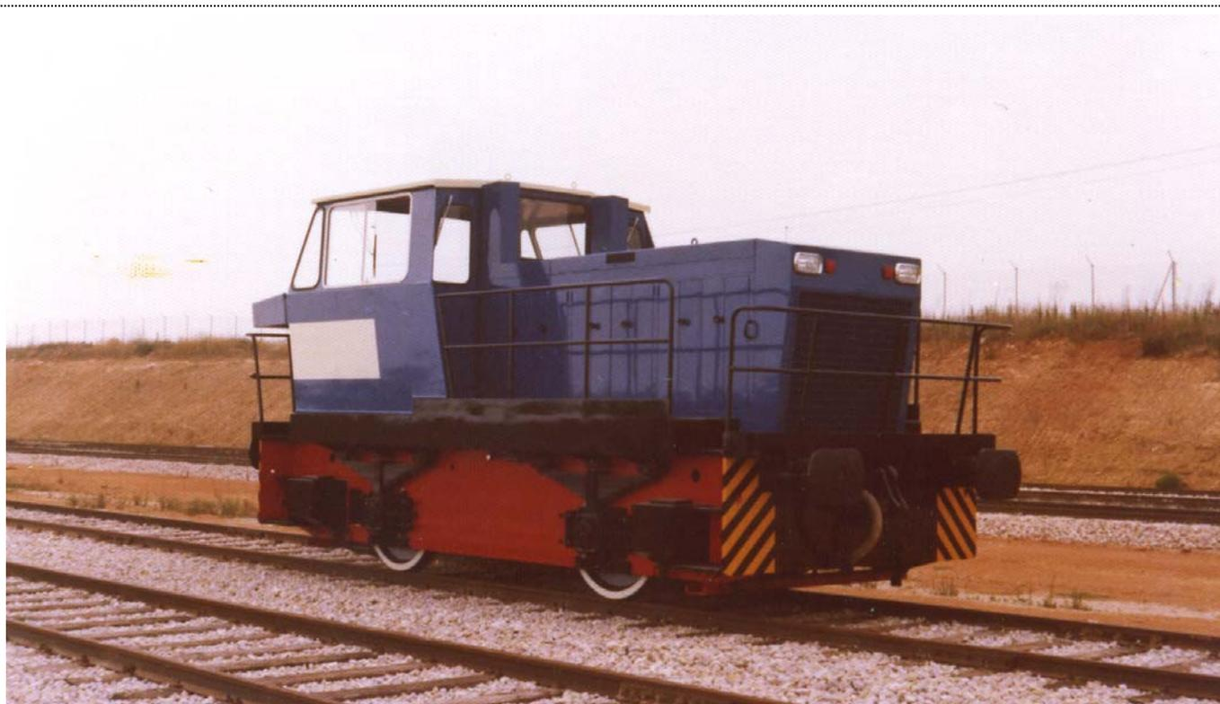
MACOSA a construit en 1975, sous licence MTE, le locotracteur « hybride » portant le numéro de construction 552, du type MYCBV-8NZ, pour l'usine Ford d'Almusafes. D'un poids de 40 tonnes, il était doté, comme ses congénères Français, d'une carrosserie type TE 1521 / 1951 et d'un châssis de conception Batiruhr / MTE – L'engin vu à sa sortie d'usine - collection Louis Caillot.
