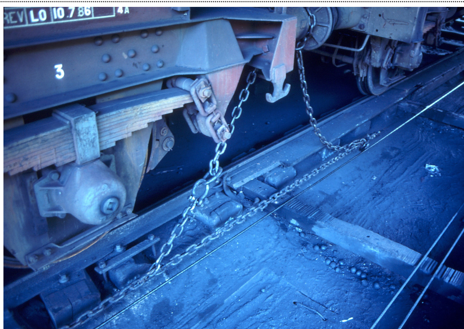
Le système de halage par câbles et chaînes en 1988 (photographie Patrick Etiévant)
