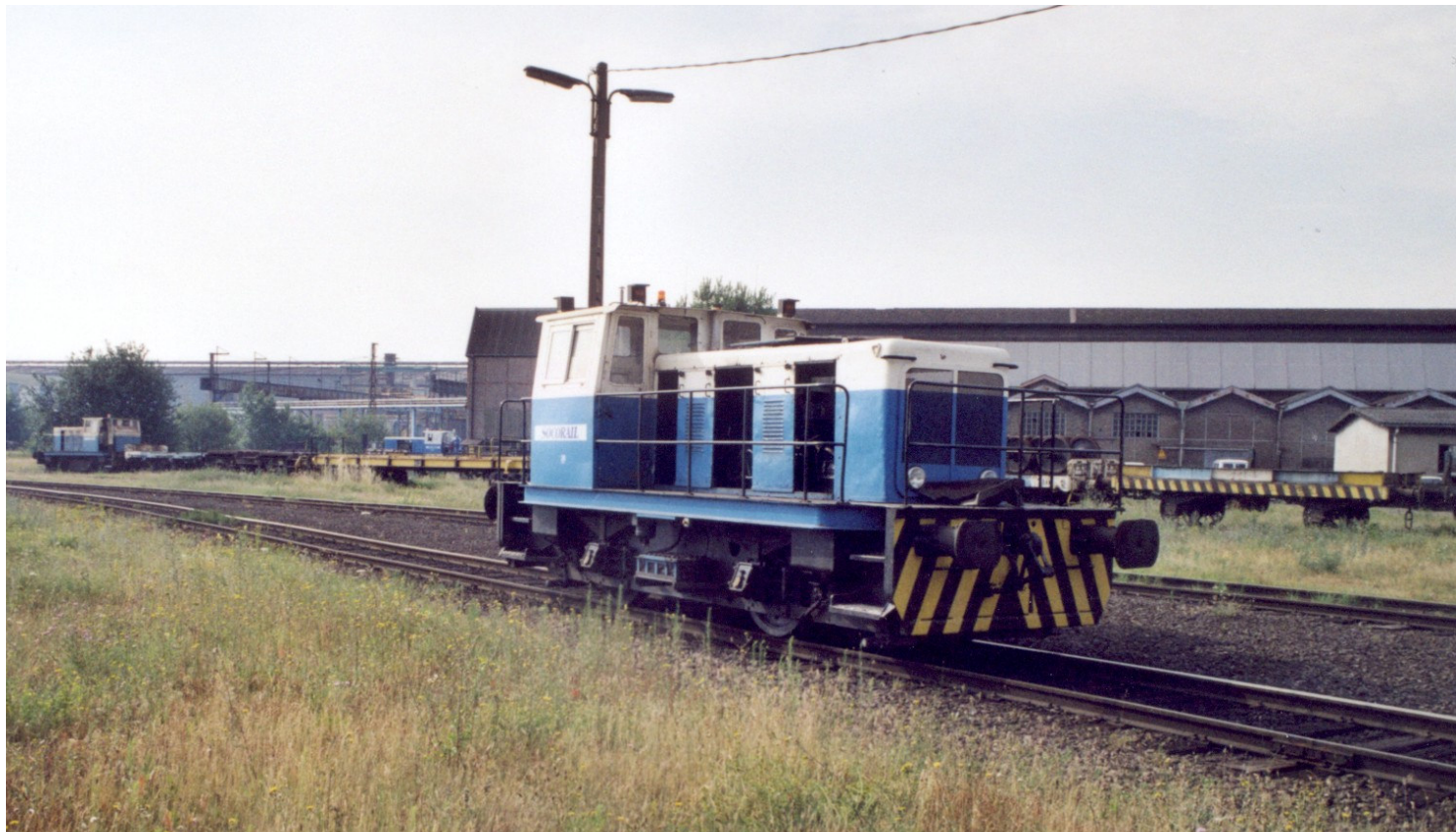
Neuves Maisons (54) — 2003 — SAM Société des Aciéries de Montereau — Jusque récemment, c'est la Société Socorail qui assurait le service de traction dans cette aciérie. Elle utilisait notamment plusieurs locotracteurs SACM Graffenstaden type 3-20 de 200 cv et 33 tonnes de tare, à moteur Willème 518T8M et transmission Voith L33Y. Celui-ci est le n°30 (12/322) fabriqué en 1962 sous le numéro 10.169. Avant son rachat par Socorail à Ugine — Aciéries et Tréfileries de Neuves Maisons, il portait le numéro NM12 (Photographie Patrick Etiévant).
