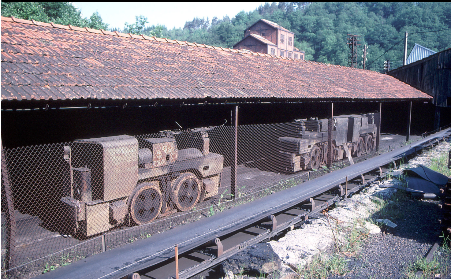
Messeix (63) — 1986 — Houillères de Messeix — Bain de soleil pour les Alsthom et SACM du roulage de l'étage 740 ; on aperçoit à gauche la locomotive électrique numéro 13 (n°1002 datant de 1943), et à droite le couplage composé des locomotives numéros 11 (n°451 datant de 1923) et 9 (n°449 datant de 1923). Plusieurs de ces locomotives sont préservées (Photographie Patrick Etiévant).
