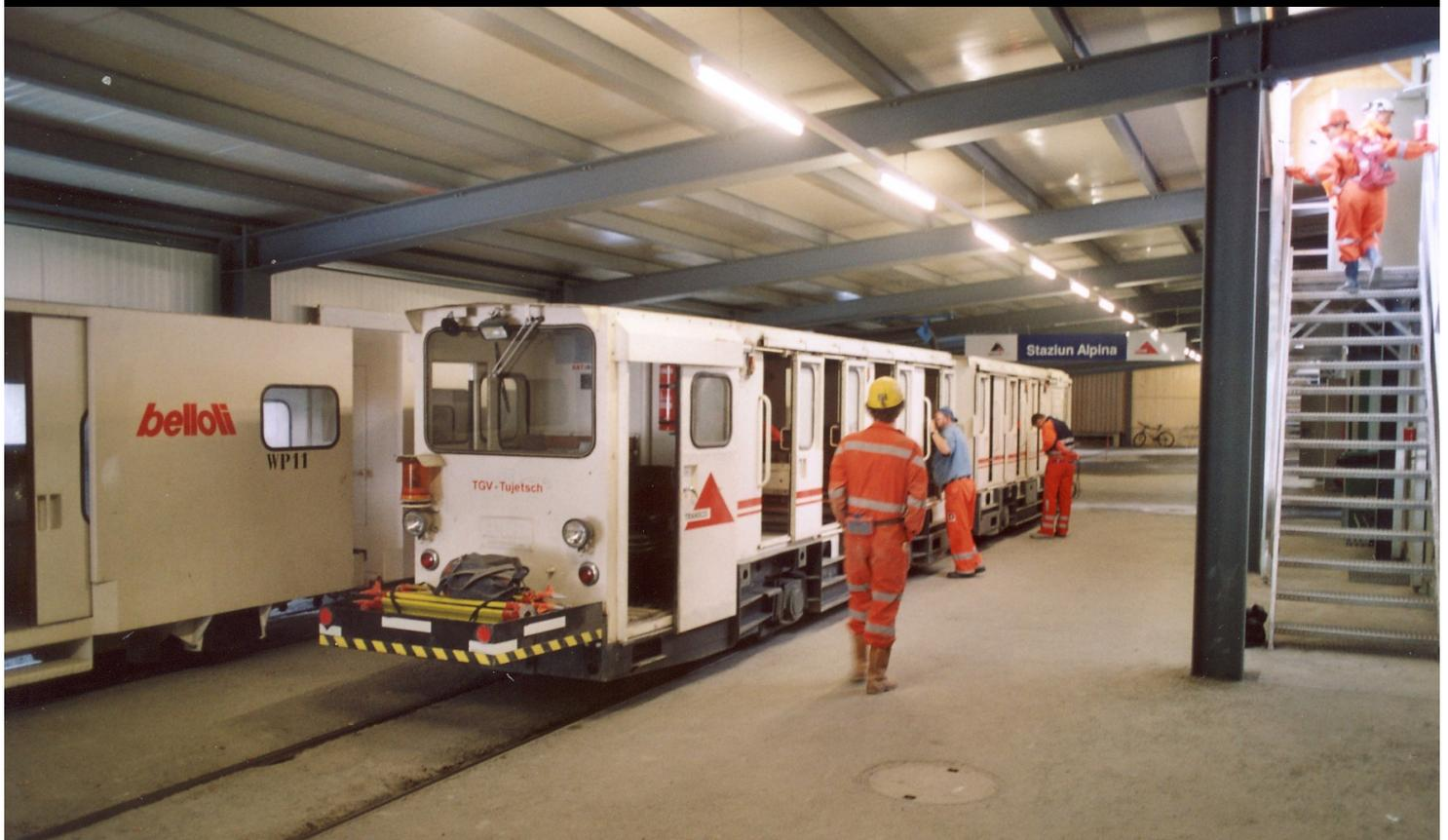
Sedrun (Suisse) — Juillet 2004 — Chantier de l'AlpTransit — L'autorail Schöma est employé essentiellement lors des changements de poste pour le transport des mineurs. L'engin, vu ici du côté de l'élément sans moteur diesel n°WP1, a été doté à l'avant d'une petite plateforme pour le transport des objets encombrants (ex : les trépieds des géomètres...), condamnant ainsi l'utilisation de l'attelage (Photographie Patrick Etiévant).
