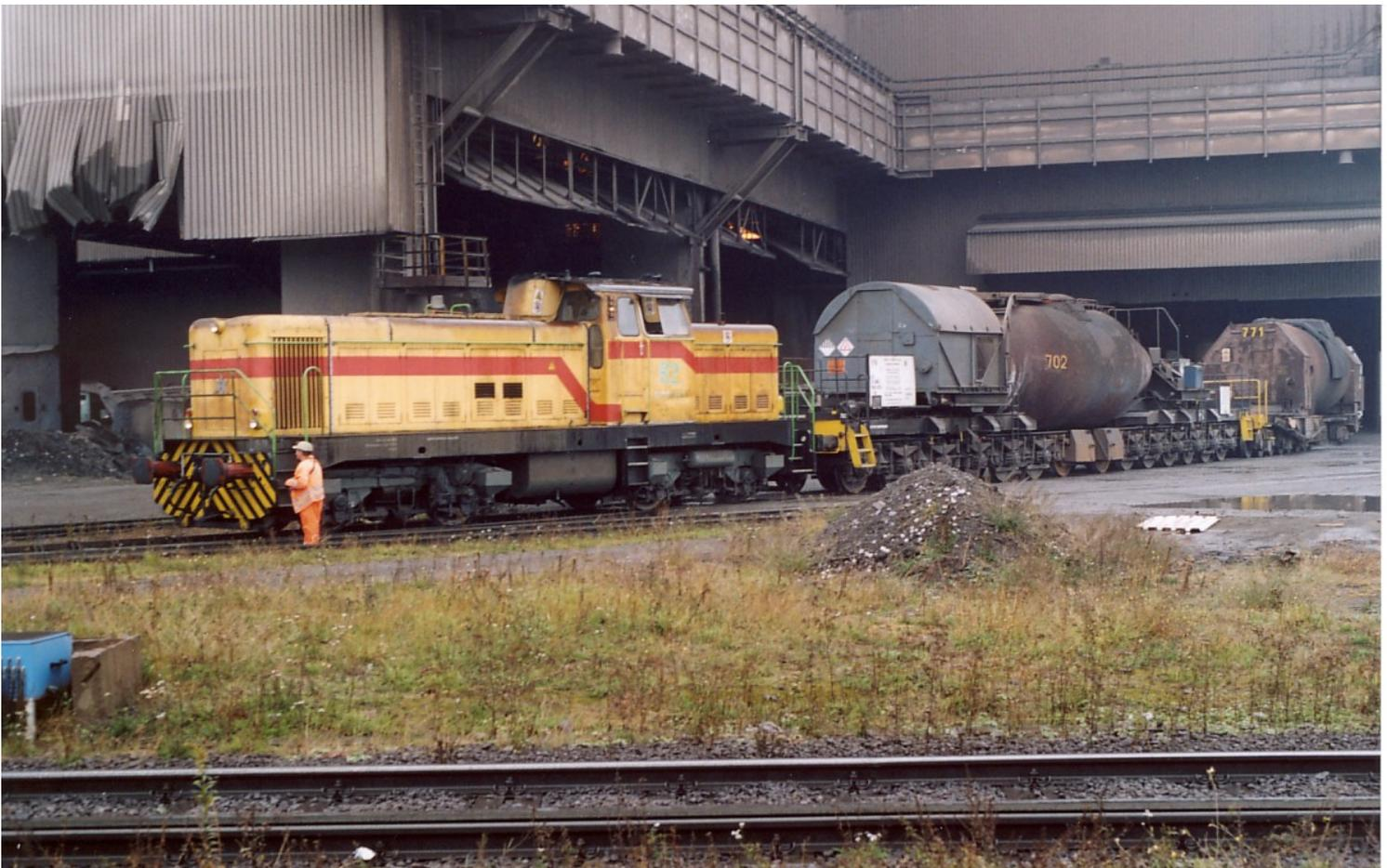
Dillingen (Sarre, Allemagne) — Mai 2003 — ROGESA — La locomotive Henschel type DHG1100 identifiée R2 (n° de construction 31.203 en date de 1965) revient de l'aciérie de Dillinger Hüttenwerke en tête d'une rame de wagons à poche torpille. On aperçoit la poche n°702 d'origine française (CAFL / Creusot-Loire), suivie par la poche n°771 d'origine allemande (PHB) (photographie Patrick Etiévant).
