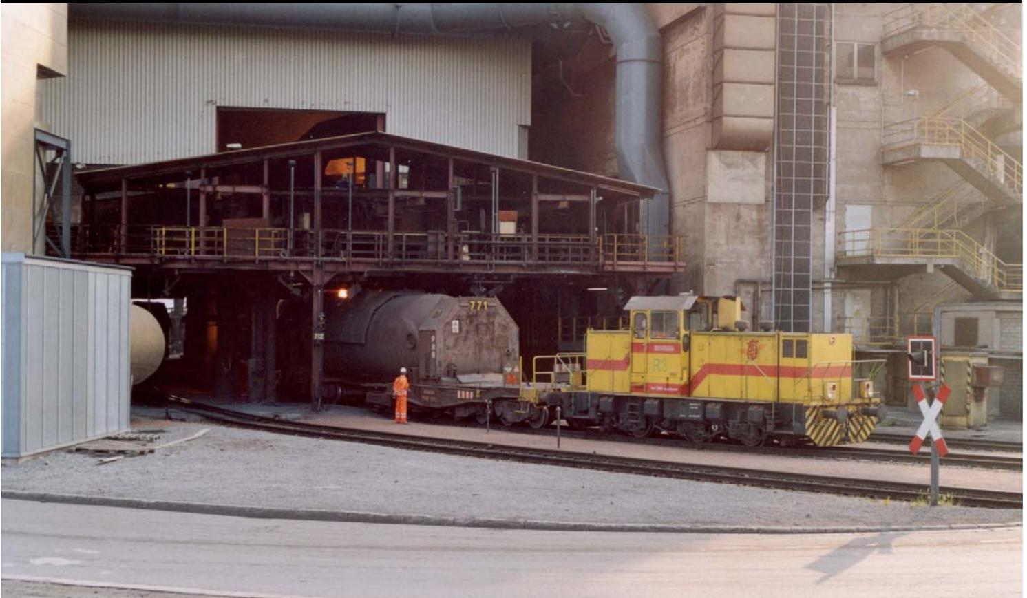
Dillingen (Sarre, Allemagne) — Mars 2004 — ROGESA — La locomotive Krauss Maffei type ME05 à transmission électrique identifiée R3 (n° de construction 19.917 datant de 1984) est prête à manœuvrer le wagon à poche torpille PHB n°771. Celui-ci est en train de recevoir son chargement de 280 tonnes de fonte en fusion coulant du haut fourneau n°4 (photographie Patrick Etiévant).
