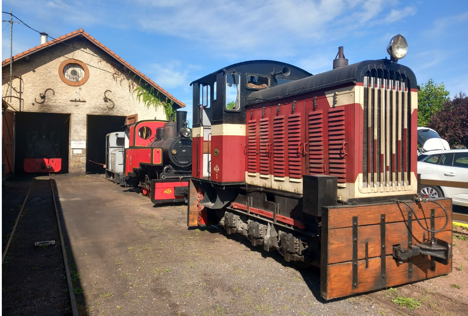
Abreschviller (57, Moselle) - Chemin de fer forestier d'Abreschviller - L'Administration des Eaux et Forêts a doté en 1953 ce chemin de fer d'un locotracteur COFERNA à trois essieux en voie de 700 mm. Il est similaire aux engins de la SCS Sucrerie Centrale du Santerre, toutefois sa cabine de conduite a été reportée à l'extrémité arrière. Le poids total est de 15 tonnes. Le moteur diesel Willem F 4 M 517 à quatre cylindres développe 100 ch - Photographie Marc Moulin -
