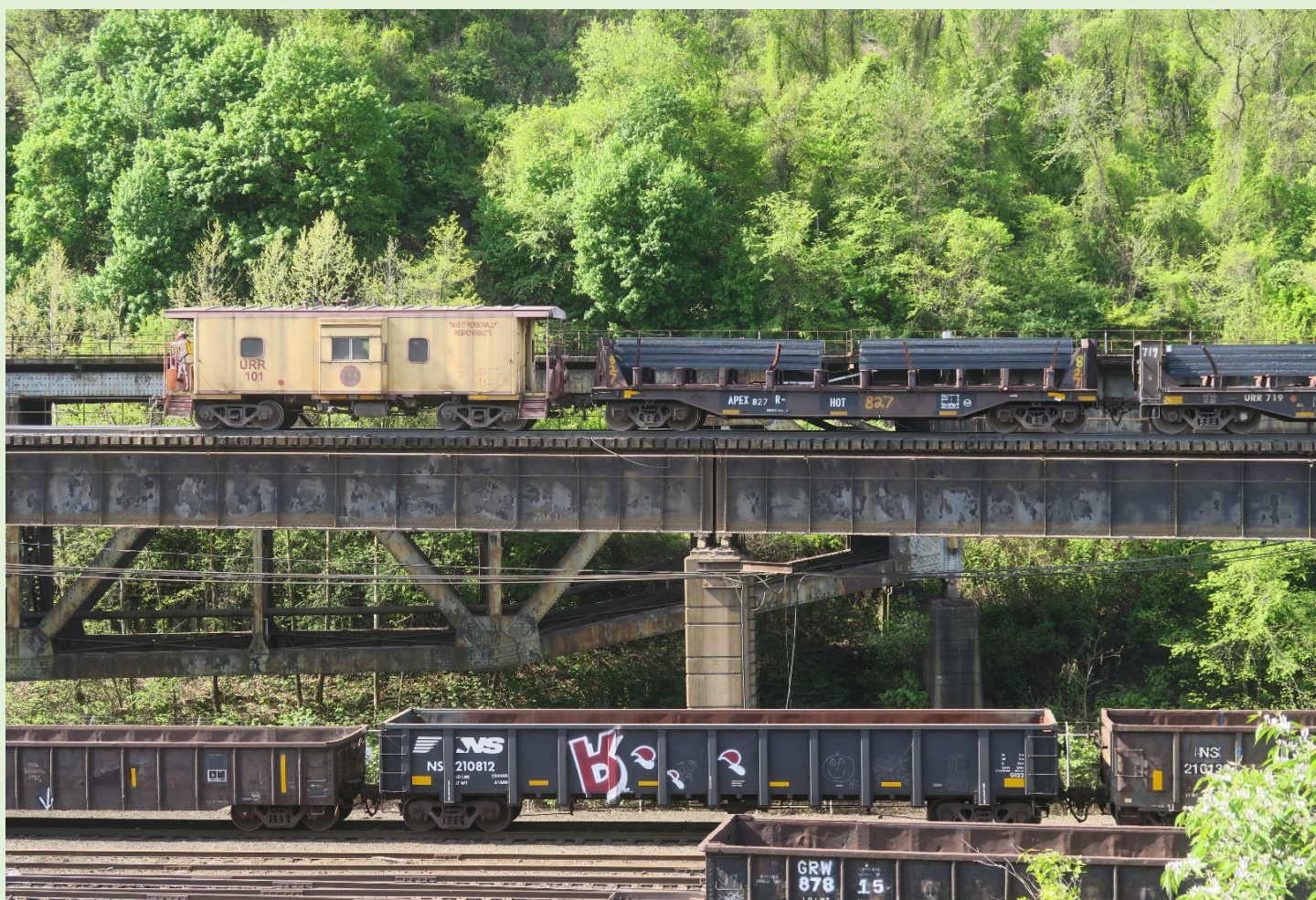
Braddock : US Steel – un train de brames chaudes sort en refoulant de l'usine. Un pilote surveille la voie depuis la plateforme du fourgon « caboose » n°URR 101, en liaison radio avec le conducteur de la locomotive. On observe l'aspect robuste des wagons de l'URR conçus pour ce type de chargement particulièrement « hot », ainsi que c'est inscrit sur le longeron. Les 8 brames doivent friser les 120 tonnes nettes... – Patrick Etiévant –
