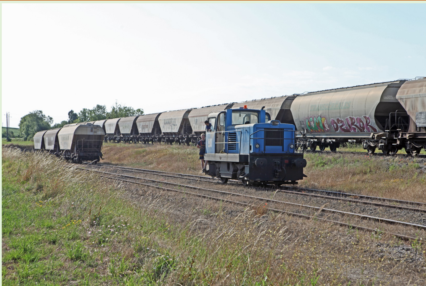
Le locotracteur Moyse type BN 34 E 210 B construit en 1978 sous le numéro 1420 vient de poser sa première coupe de wagons chargés en céréales sur la voie de garage de droite – Patrick Etiévant –
