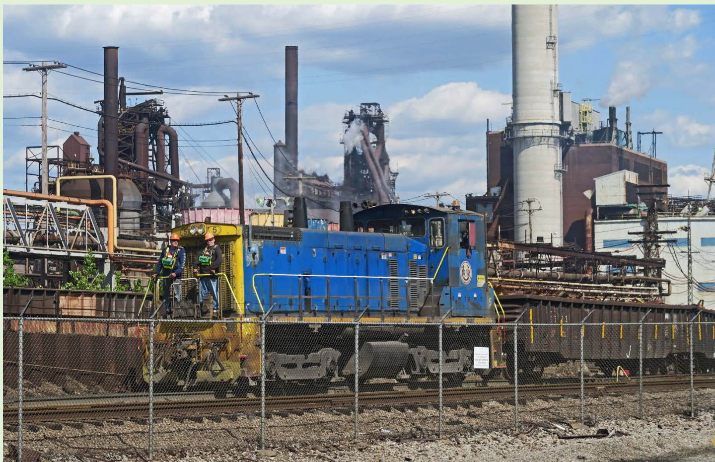
Braddock : US Steel – un train de wagons-tombereaux (gondolas) chargés de ferrailles se dirige vers l'aciérie sur la voie qui longe la rivière Monongahela ; c'est la locomotive BB EMD-GM (Electro-Motive-Diesel, General-Motors) type SW1500 n°5 de l'URR qui assure la traction – Patrick Etiévant –
