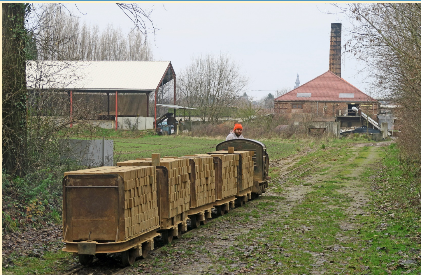
Le locotracteur Heim en voie de 500 mm revient des séchoirs avec 5 chariots plats chargés de briques crues. Au second plan, à droite, on peut voir le four Hoffmann, et à gauche le hangar servant à stocker l'argile pour la fabrication des briques pendant l'hiver. On devine la voie de 600 mm qui court en parallèle à gauche, et le Plymouth sous le hangar vers la sauterelle - Photographie Patrick Etiévant -
