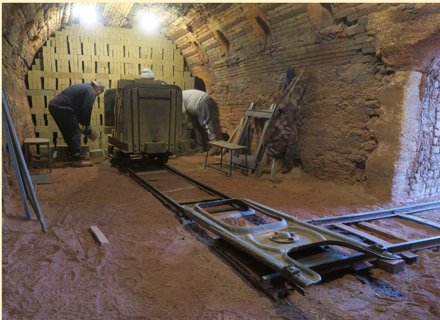
Le chargement des briques crues dans la galerie du four. Au premier plan, un saute-rail - Photographie Patrick Etiévant -
