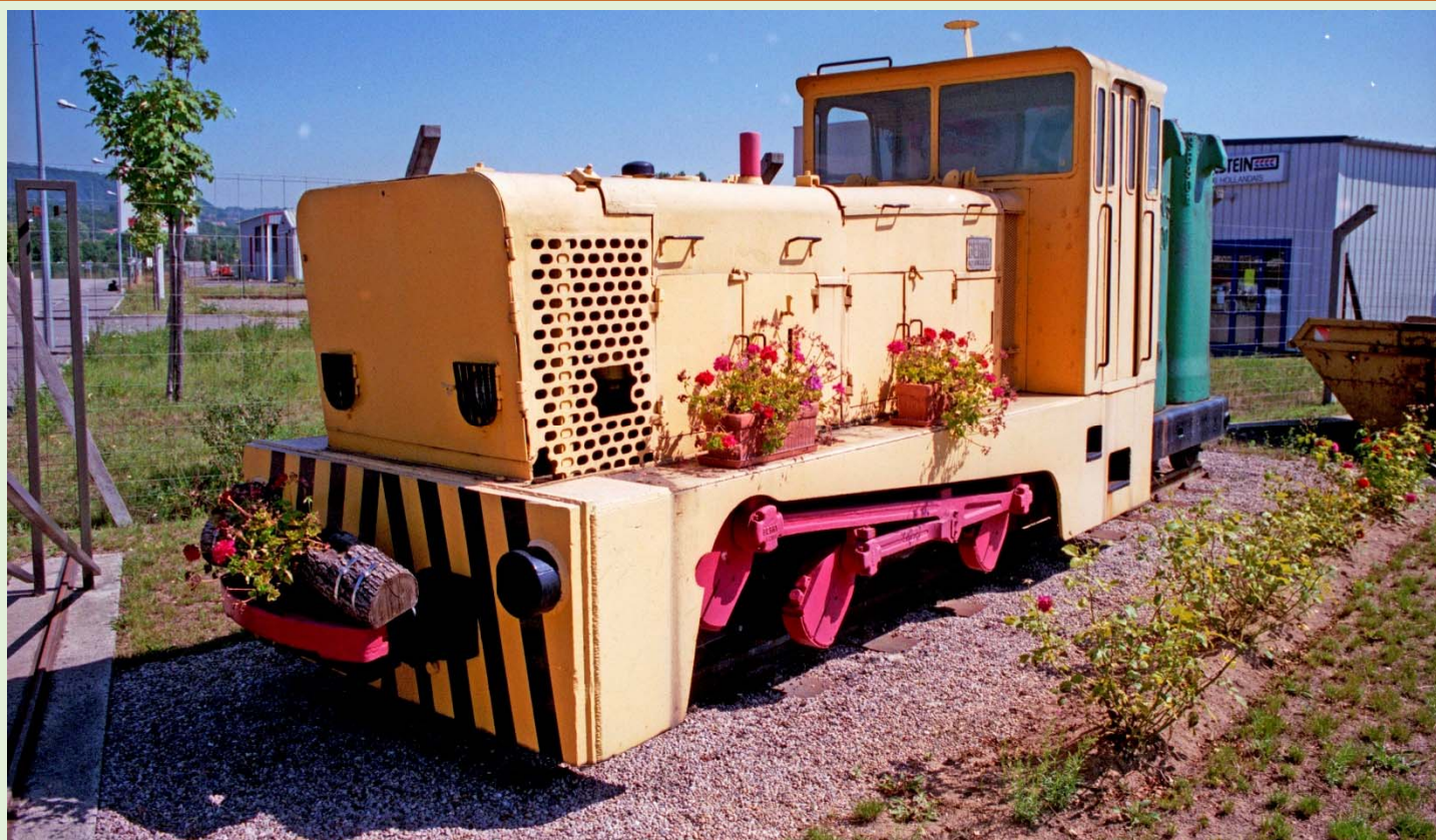
Le Berry 3598 P4 de Chatillon-Commentry-Neuves-Maisons CCNM vu à Neuves-Maisons (54). Il était en voie de 770, moteur Poyaud 4 PXi de 150 chevaux, tare 17 tonnes, construit sous le n°785 en 1958 – Photographie Patrick Etiévant -.
