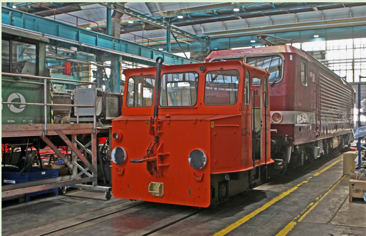
Atelier central de maintenance ferroviaire (MCR) de Schwarze-Pumpe : on observe un des engins de manœuvre fonctionnant sur batteries (Akkuschleppfahrzeuge ASF) construits par LEW type EL16 identifié ASF n°4. Le locotracteur vient de positionner l'essieu avant de la locomotive BR 243-005-6 (qui fait partie de la flotte de DB-Museum si nos renseignements sont corrects) sur le tour à roues en fosse afin de reprofiler les essieux du bogie avant. Le MCR possède toutes les certifications et les outils nécessaires pour mettre en conformité le matériel ferroviaire selon les règles DB et Europe – Photographie Patrick Etiévant -
