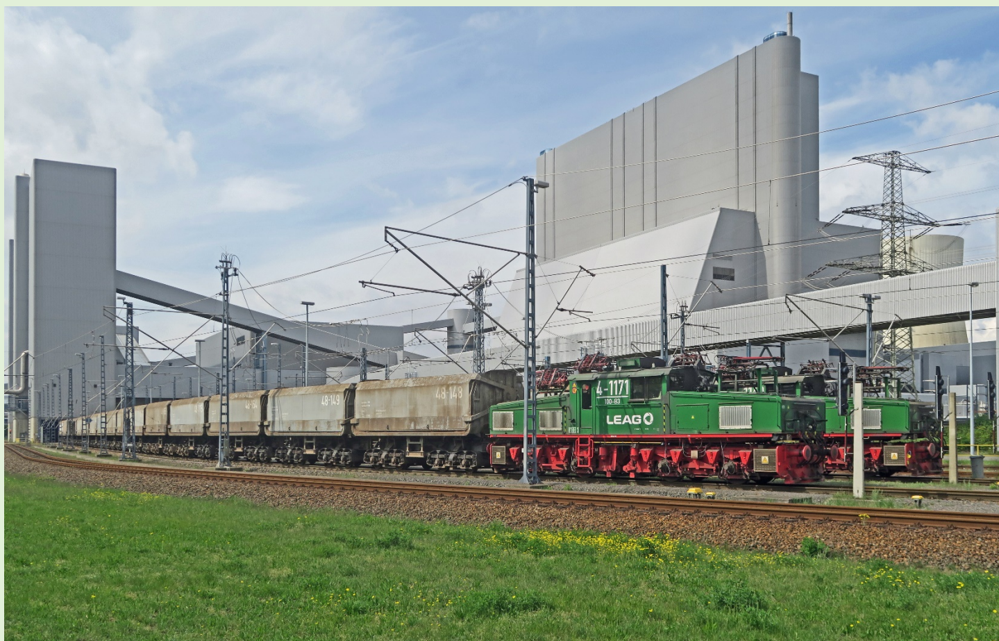
Schwarze-Pumpe : le profane peut-il se douter que cette centrale thermique, la première de la nouvelle génération (1993), avec son architecture moderniste immaculée et impeccable, brûle du lignite brun poussiéreux et cendreux depuis plus de 30 ans ? On observe deux trains de cendres, composés de wagons à caisse basculante unilatérale de 48 m 3 , en attente de chargement sous les silos à gauche – Photographie Patrick Etiévant -
